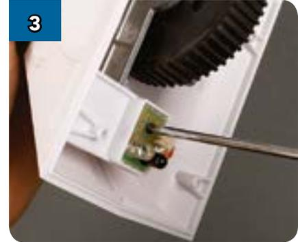
3 Открутите саморез, который фиксирует на месте инфракрасный датчик.
