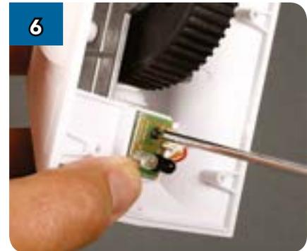
6 Установите датчик обратно на своё место и закрепите его саморезом.
